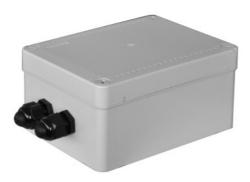
L'alimentatore da esterno su scatola stagna mod. PS4 consente di alimentare i fari IR mod. **NYX ELI** 160-160DI direttamente da tensione di rete a 230Vac con una potenza in uscita di 100VA dando così la massima flessibilità di installazione. A completamento della gamma si può avere lo stesso alimentatore predisposto però con tensione di alimentazione a 110Vac.
